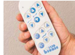
Der bedienerfreundliche Handschalter mit fest programmierter Liege- und Sitzposition ermöglicht eine einfache individuelle Einstellung.
